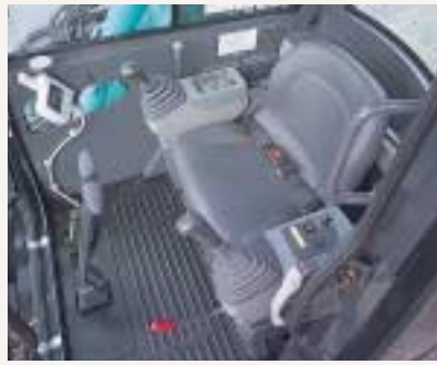
写真:50UR キャブ/ハイリーチクレーン仕様 *ディスプレイと水準器はハイリーチクレーンの装備品です。
