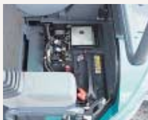
シートを倒せば容易にリレーボッ クスの点検が可能。
