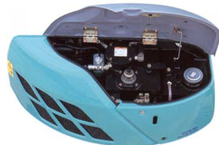
●外部ゲージで確認できる作動油タンクは、圧抜きブリーザ付き。
