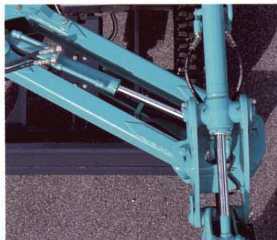
●油圧配管もオフセットシリンダも内蔵したコベルコ独自の平行リンク式オフセットブーム。
