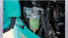
ボンネット内の最前面に設置したウォーターセパレータ。
