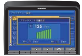
クラッシャ等アタッチメント (アタッチメントモード時)
